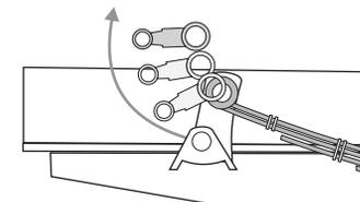
1) INSTALE EL KIT EN EL BUJE DE LA MUELLE , COLOQUE EL TORNILLO, RONDANA Y TUERCA QUE RETIRO ANTERIORMENTE.
